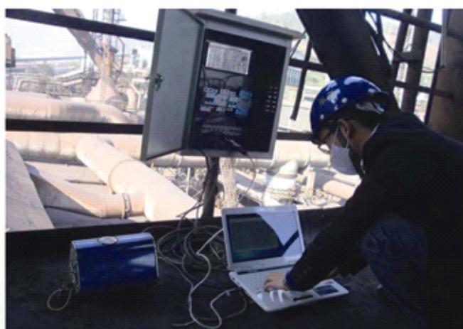
攀钢高炉顶部逸散粉尘浓度监测
